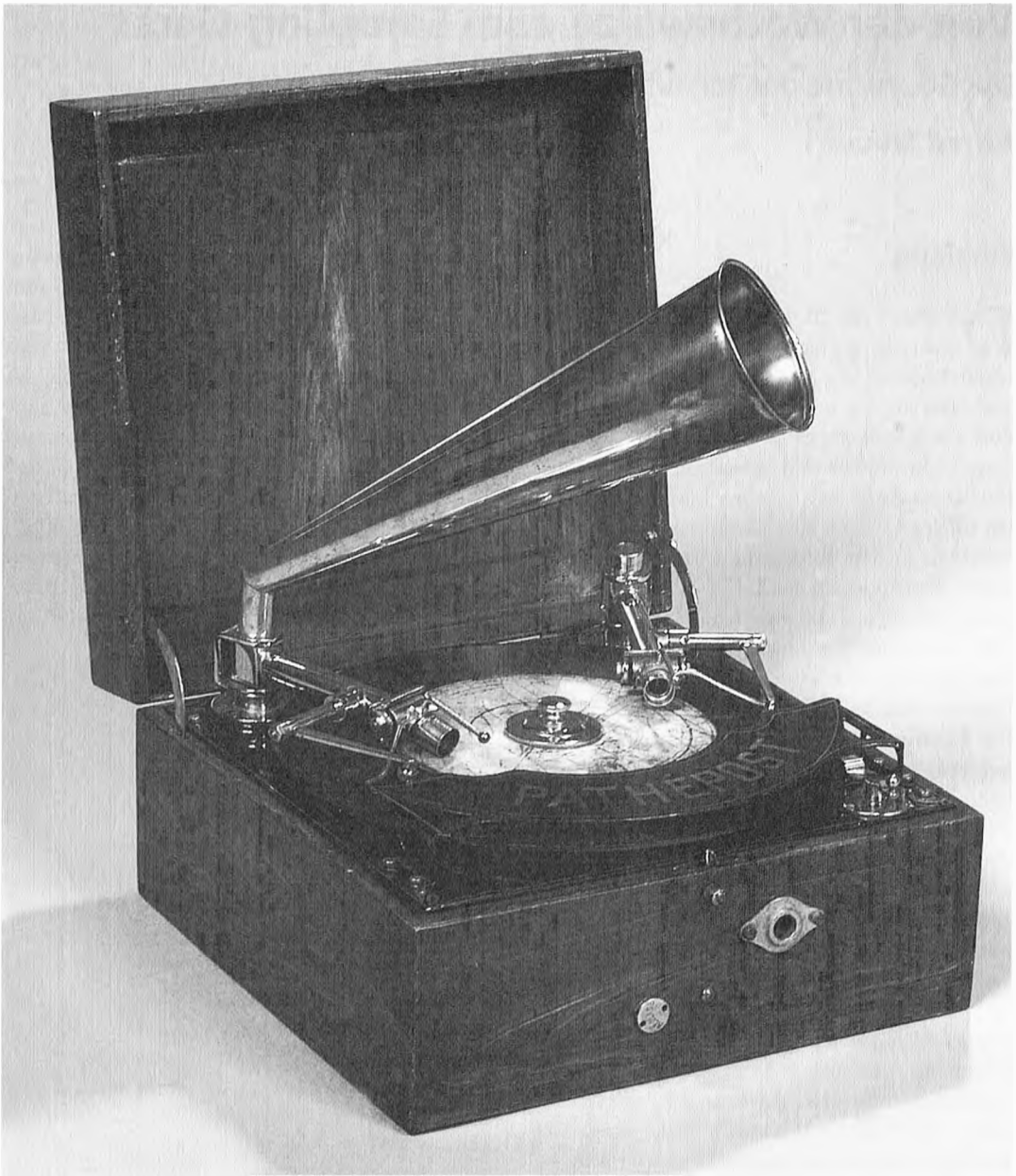
Abb. 2: Plattenaufnahme- und wiedergabegerät Pathépost. Foto: medien.welten im Technischen Museum Wien
